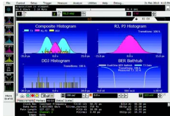
快速表征抖动和显示直方图、测量趋势和抖动频谱。
