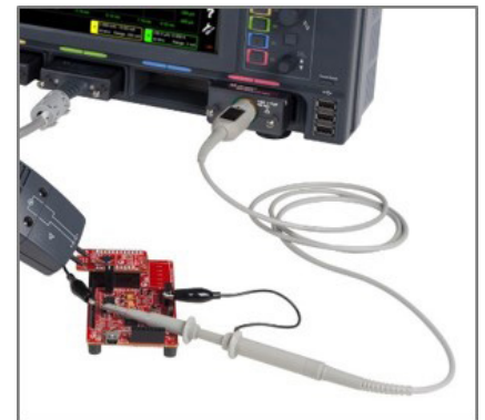
圖 32：使用被動式探棒進行電壓量測的範例。
