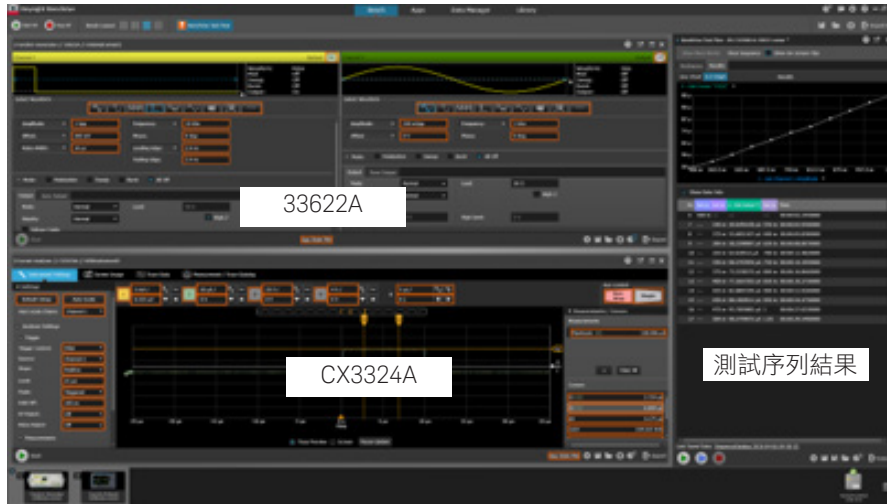
圖 41：使用 CX3324A 和 33622A 的 BenchVue 電流分析儀應用範例。
