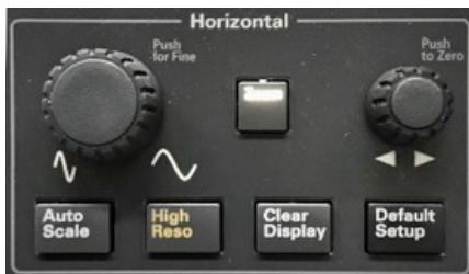
圖 15：可設定 16 位元解析度的高解析度按鈕。
